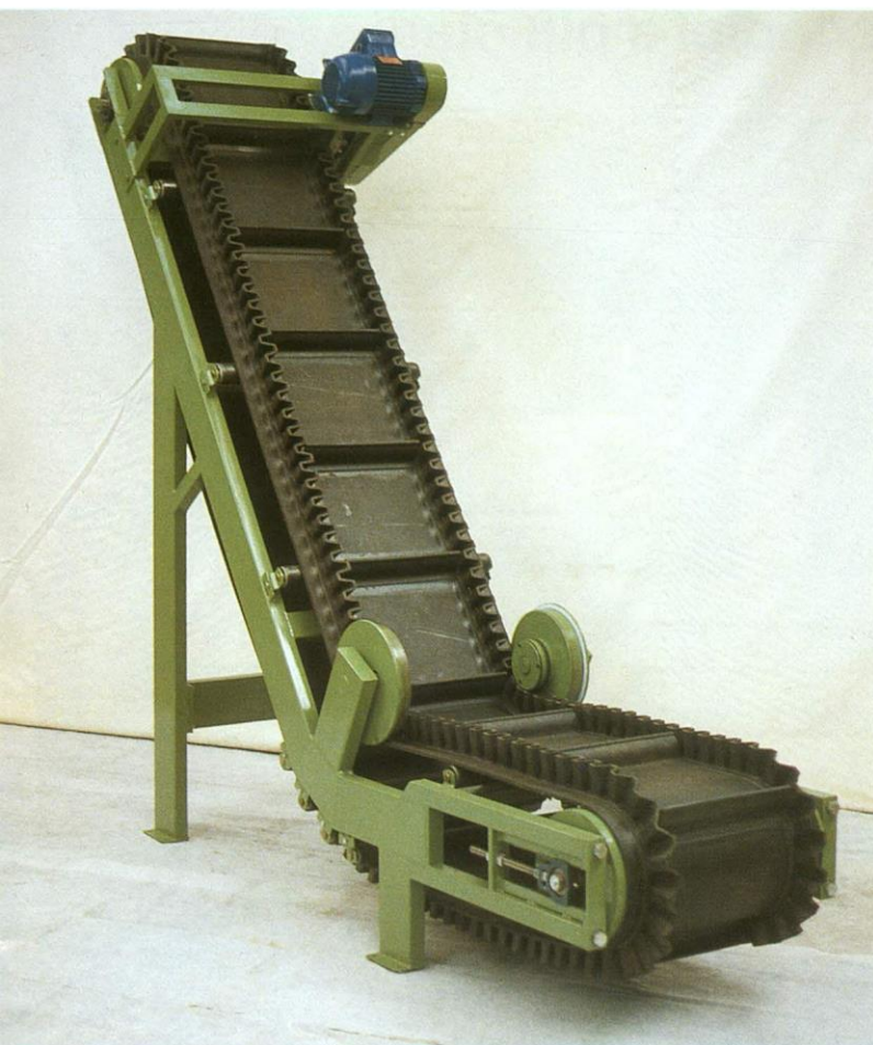
Art. 48.OX TRASPORTATORE A NASTRO DI GOMMA con bordi laterali di contenimento tipo ondaflex, per il trasporto di materiali sfusi in verticale od orrizzontale. Esecuzione con singola o doppia curva. Dimensioni e portate a richiesta.
