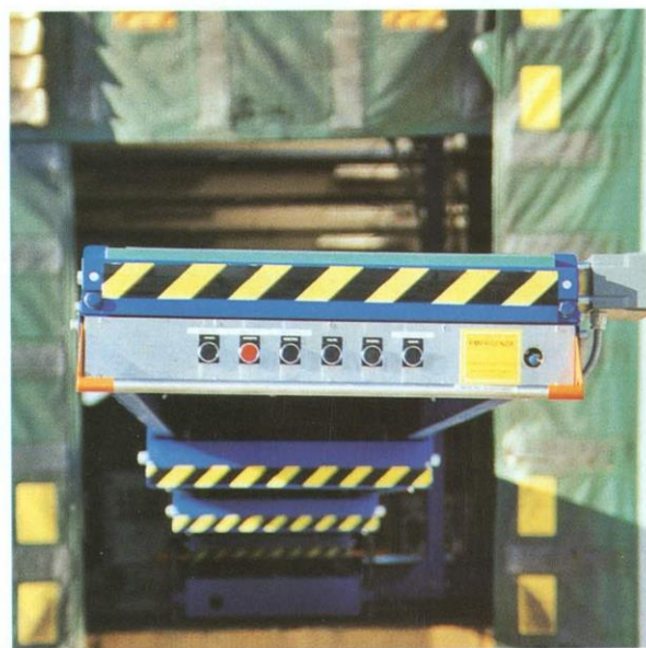
Particolare pulsantiera di comando.
